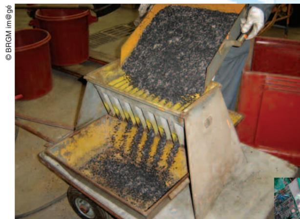
Travaux sur la mise au point d'un protocole d'échantillonnage de granulats de pneus usagés non réutilisables (PUNR).
