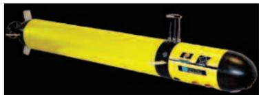
Véhicule sous-marin autonome (TAIPAN II) développé au LIRMM de l'Université de Montpellier II.
