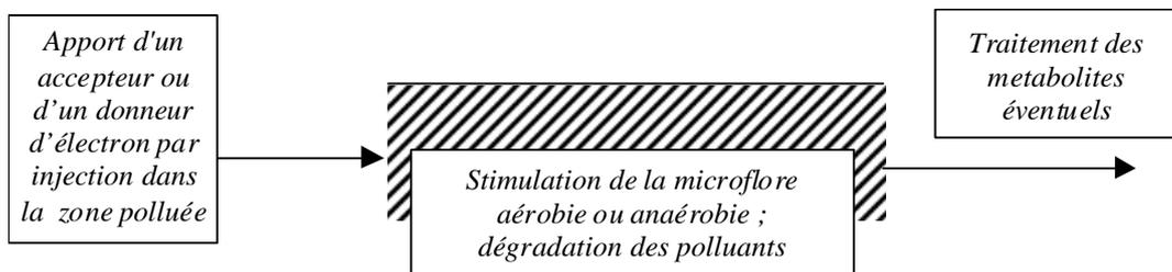
**Figure 32 - Schéma de principe du traitement par biodégradation stimulée in situ de sols pollués**
