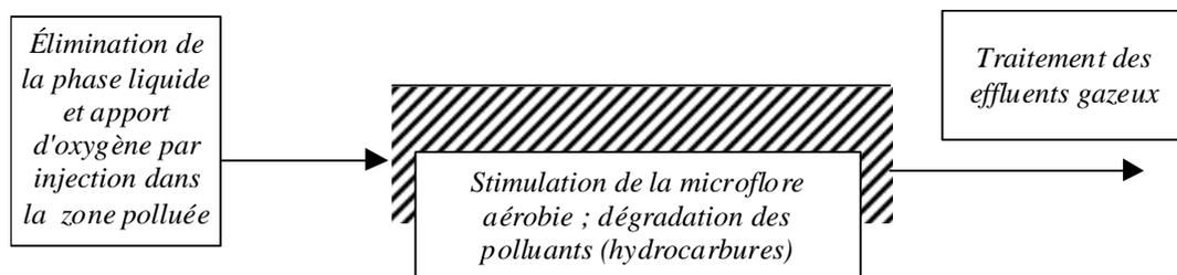
**Figure 28 - Schéma de principe du traitement par bioventing de sols pollués par des hydrocarbures**
